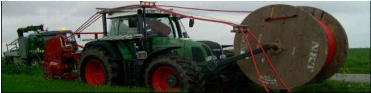
Traktor til udlægning af kabler eller jordradiatorer
